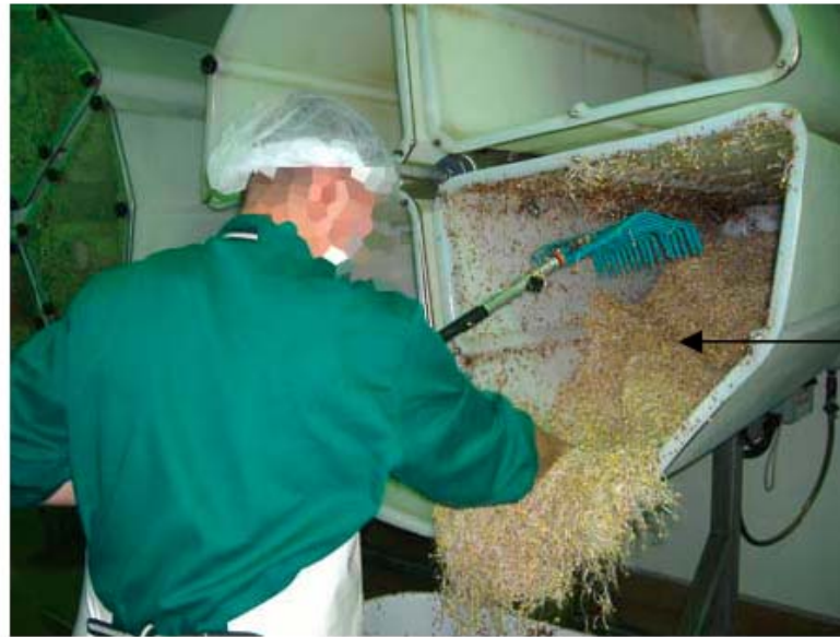
Abb. 5: Kunststoffkörbe als sich drehende Trommel mit Bewässerung durch Produktionswasser aus dem Brunnen (enteisent, aufgehärtet). (Abb. des Betriebes )
